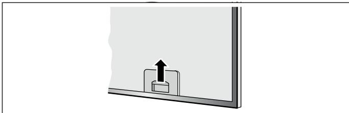
1. Ανοίξτε τη μαντάλωση των μεταλλικών φίλτρων λίπους και αφαιρέστε τα φίλτρα από το στήριγμα.
