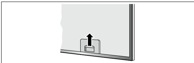
1. Откройте фиксатор металлических жироулавливающих фильтров и извлеките фильтры из крепления,
